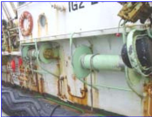
写真2 . ローラから離れた場所にある操作装置
